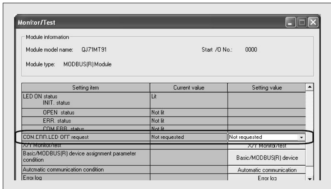
Abb. 12-10: Die Anforderung zum Ausschalten der LED „COM.ERR.“ ist gelöscht.
